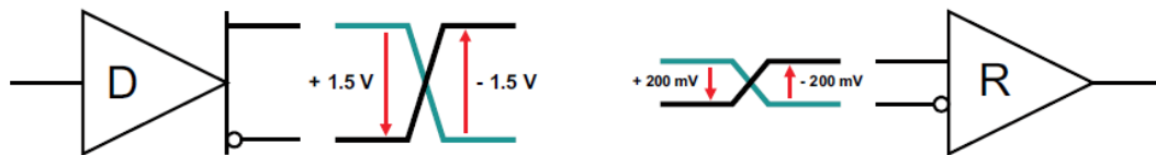
14-1. ábra: Differenciális jelátvitel [41]
