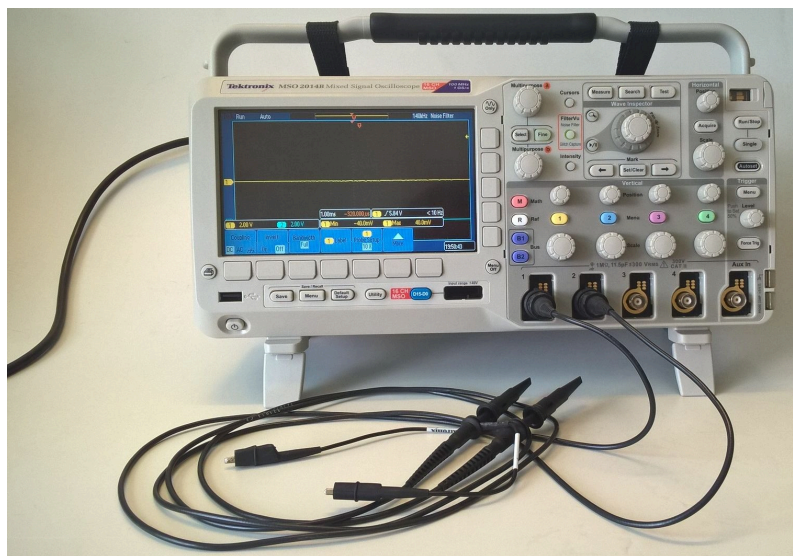
4.2. ábra. Digitális oszcilloszkóp mérőkábelekkel.
