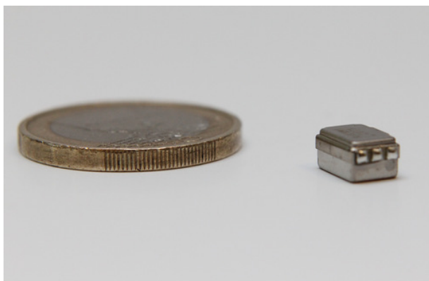
10.2. ábra. Piezoelektromos gyorsulásérzékelő.
