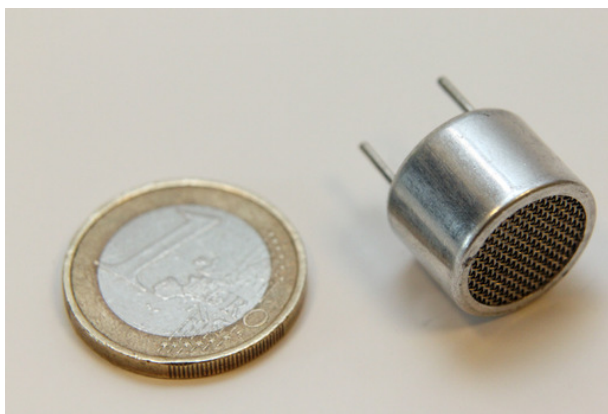
10.1. ábra. Piezoelektromos ultrahang adó (vevő) kapszula.
