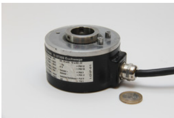
7.2. ábra. Inkrementális enkóder tengelyes csatlakozással.
