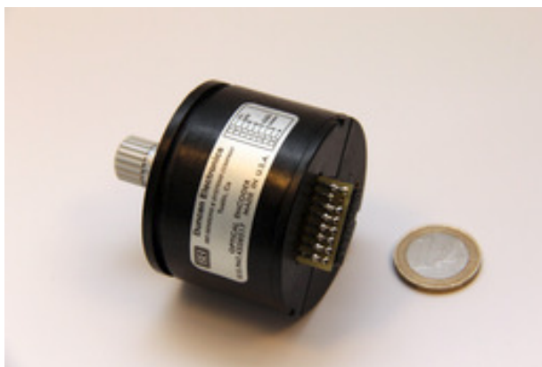
7.2. ábra. Inkrementális enkóder tengelyes csatlakozással.
